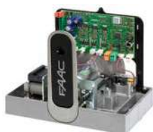
Tarjeta electrónica E721 (incorporada en el accionamiento) compatible con C720 y C721
