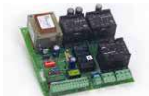
Tarjeta electrónica 884 T (incorporada en el accionamiento)
