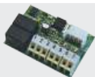
B EBA IO DRIVER - P111466 Tarjeta de expansión INPUT/OUTPUT
