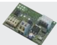
B EBA RS 485 LINK - P111468 Tarjeta de expansión para la conexión de grupos de centrales con gestión de los mandos seriales
